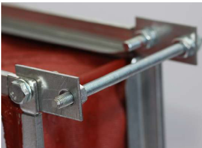
Fot.5. Należy usunąć zewnętrzną nakrętkę i podkładkę w czterech narożnikach po jednej stronie kompensatora by stan zgadzał się z fotografią.
