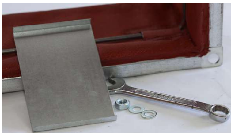
Fot.8. Należy usunąć dwie blaszki rozporowe oraz po cztery śruby i osiem podkładek z jednej sztuki kompensatora.
