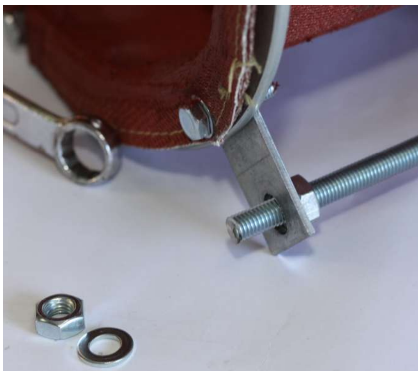
Fot.6. Należy usunąć zewnętrzną nakrętkę i podkładkę w dwóch miejscach po jednej stronie kompensatora by stan zgadzał się z fotografią.
