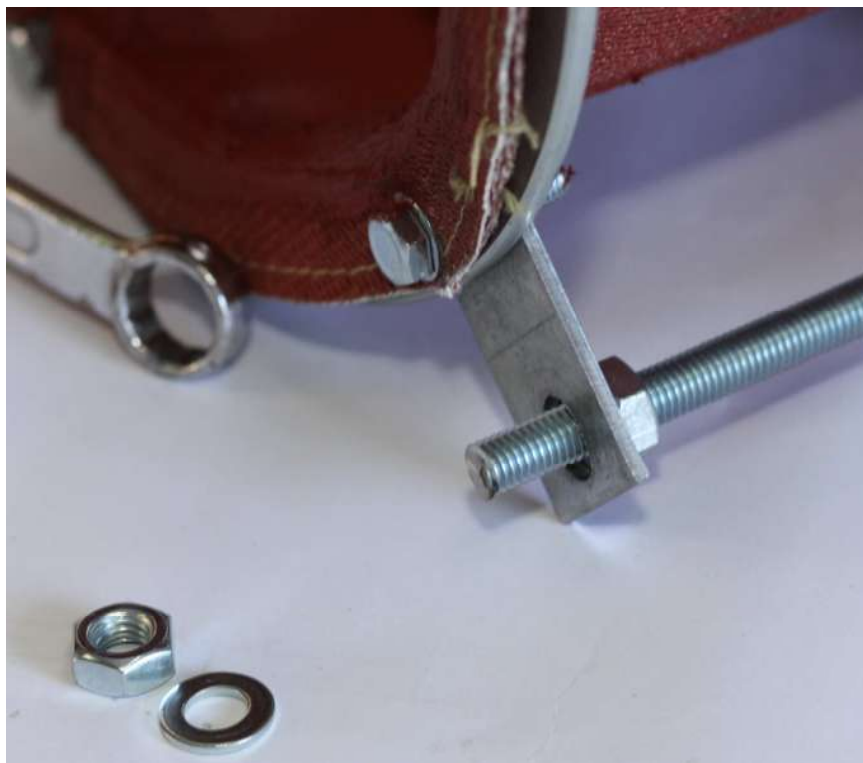
Fot.3. Należy usunąć zewnętrzną nakrętkę i podkładkę w dwóch miejscach po jednej stronie kompensatora by stan zgadzał się z fotografią.
