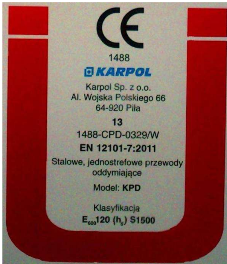
Fot.1. – Wzór etykiety na kanały prostokątne oddymiające.
